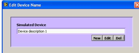
Im Dialog „Edit Device Name“ kann der Anwender ein simuliertes Gerät erzeugen, die Bezeichnung für ein simuliertes Gerät ändern oder ein simuliertes Gerät löschen.
