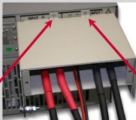
**Oberteil des Berührungsschutzes an die Rückwand schrauben**
