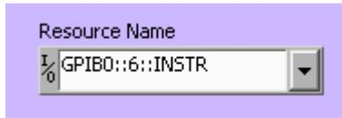
Bei gewählter GPIB Schnittstelle muss die **GPIB Adresse** mit der an der Last eingestellten übereinstimmen. Tragen Sie dazu die entsprechende Adresse zwischen den 2 Doppelpunkten als Zahlenwert ein. Mehr zur GPIB Schnittstelle finden Sie im Software-Handbuch.
